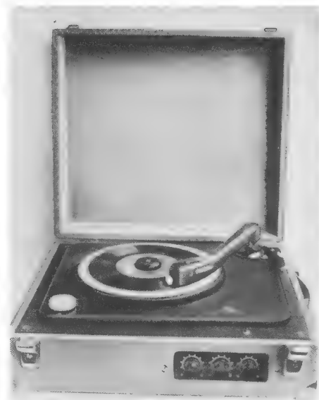
Bild 2. Der Plattenspieler und der Entzerrerteil in einem handlichen Koffer vereint
