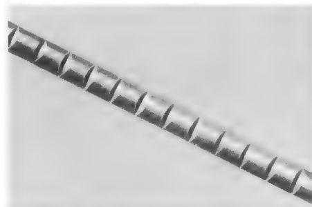
Bild 1a. Gitterholm mit eingeschnittenen Kerben (vergrößert)
